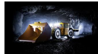
Epiroc Scooptram ST7 Battery är del av bolagets utveckling mot fossilfria gruvor
