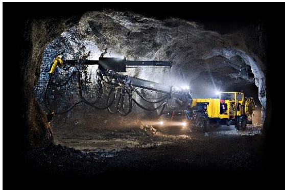
En Atlas Copco Meyco ME5 mobil betongspruta
