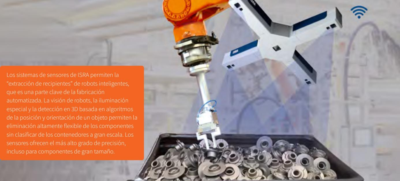
Los sistemas de sensores de ISRA permiten la “extracción de recipientes” de robots inteligentes, que es una parte clave de la fabricación automatizada. La visión de robots, la iluminación especial y la detección en 3D basada en algoritmos de la posición y orientación de un objeto permiten la eliminación altamente flexible de los componentes sin clasificar de los contenedores a gran escala. Los sensores ofrecen el más alto grado de precisión, incluso para componentes de gran tamaño.
