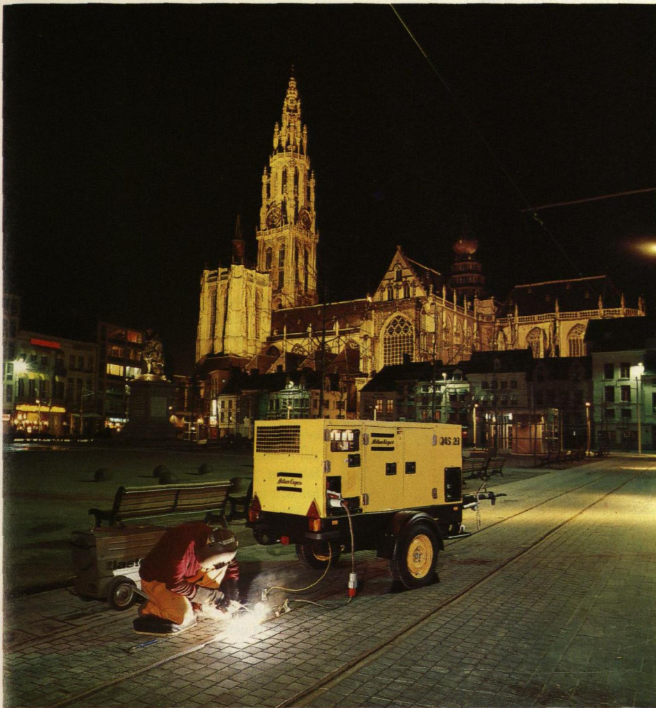
En Atlas Copco-generator, som används för svetsning av spårvägräls i Antwerpen.
