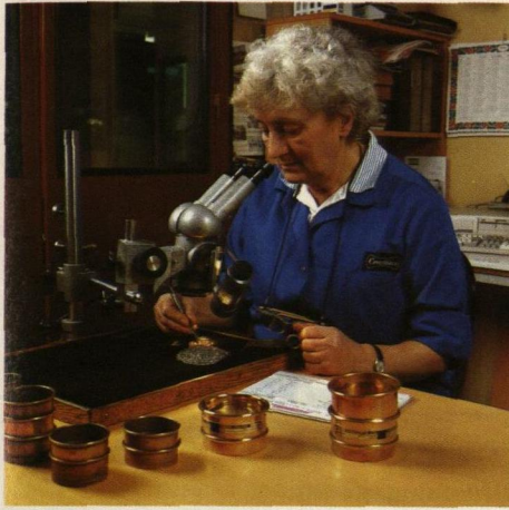
Sortering av diamanter för montering i diaman- borrkronor vid Craelius i Märsta.
