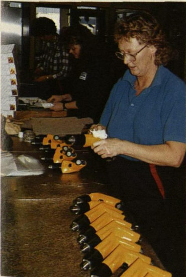
Slutkontroll av tryckluftverktyg i Tierfabriken.
