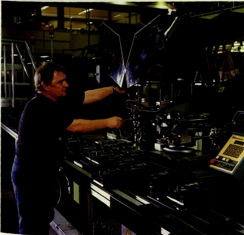
En lindningsstation i den helautomatiska monteringslinjen för rotorerna till elverktyg i Winnenden, Tyskland.
