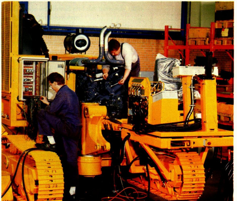
Montering av borrhavn i Bremen.
