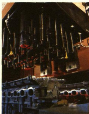
Omslag: Ett monteringsystem med 49 spindlar för åtdragning av muttrar vid motortillverkning. Det avancerade datastyrda kontrollsystemet MACS svarar för kvalitetssäkringen.
