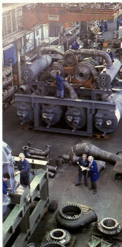
Montering av en 6-stegs turbokompressor vid ACTs fabrik i Köln. Tack vare standardiserad teknik för montering av de olika komponenterna har produktionstiden kunnat förkortas avsevärt.
