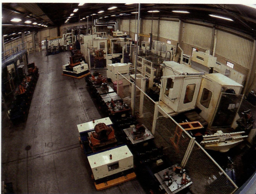
Ett flexibelt tillverkningssystem i Airpowers fabrik i Antwerpen har förkortat produktionstiden för komponenter från flera veckor till ett dygn.
