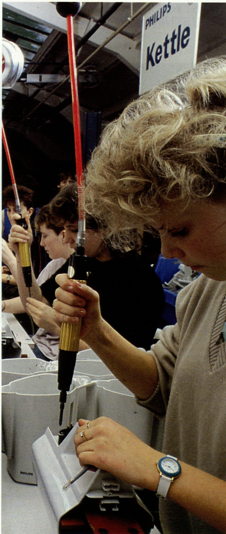
Ergoline smörjfria skruvdragare med låg ljud- och vibrationsnivå används för montering av bl a kaffebryggare.
