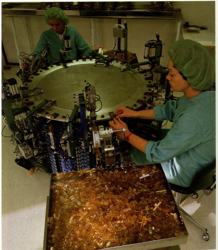
Vid J S Medical i Husvarna styrs monteringsrobotar med pneumatiska styrsystem från Monsun-Tison, som även levererat tryckluftscylindrarna. Monteringen avser engångsartiklar för sjukvården.
