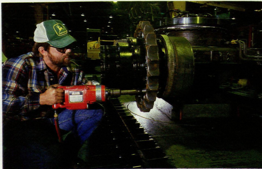
Chicago Pneumatic har en mycket stark ställning som leverantör av tryckluftverktyg till den amerikanska industrin. Till John Deere i Davenport, USA, har bl a mutterdragare levererats för montering av drivhjul.
