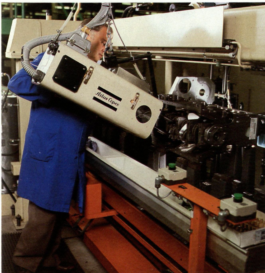
Vevstaksöverfall monteras med denna Atlas Copco halvautomatiska mutterdragarutrustning hos Cummins dieselmotorfabrik i Darlington, England. Monteringen styrs och övervakas av ett Atlas Copco MACS system. Utrustningen valdes på grund av dess stora noggrannhet och systemets goda egenskaper för statistisk utvärdering.
