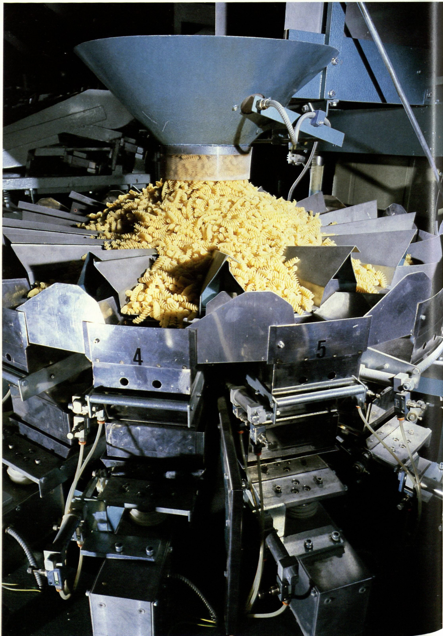
Monsun-Tison levererar pneumatikkomponenter till Ricciarellis förpackningsmaskiner. Vid ett mindre företag i södra Italien vägs pasta upp och fylls i rätt mängd i påsar med hjälp av pneumatik – automatiskt och hygieniskt.
