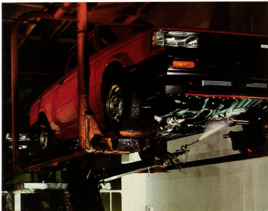
Robotar tar alltmer över smutsiga jobb. Vid Nissans fabrik i Smyrna, USA, sprutar Atlas Copco Coat-A-Matic en skyddande vaxmassa (protective wax coating) för effektivt rostskydd till låg kostnad.
