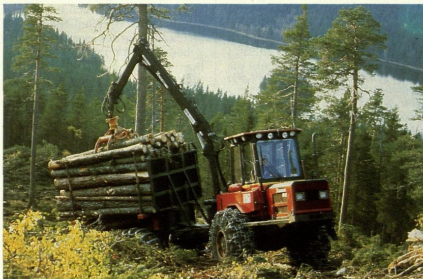
Monsun-Tisons hydrauliska styrsystem har gjort det enklare och snabbare att manövrera kranarna på skogsmaskiner för lastning av virke i skogen.
