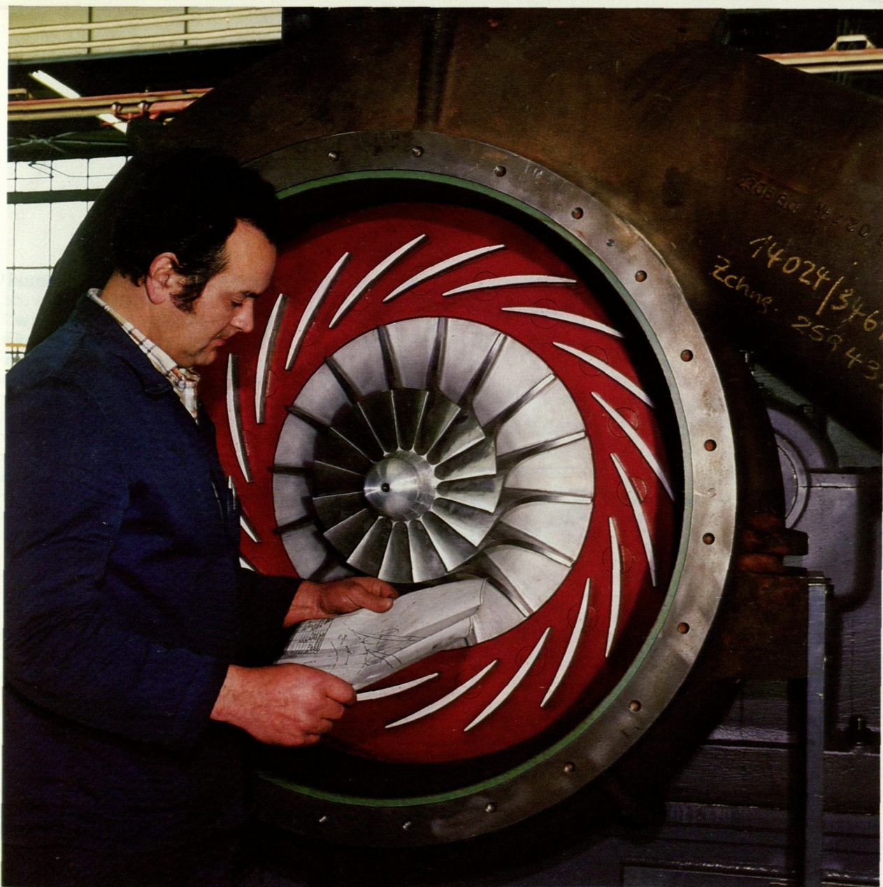
Montering av en turbokompressor vid Atlas Copco Energas verkstäder i Köln. Detta är ett nytt teknikområde som Atlas Copco erbjuder världsmarknaden.
