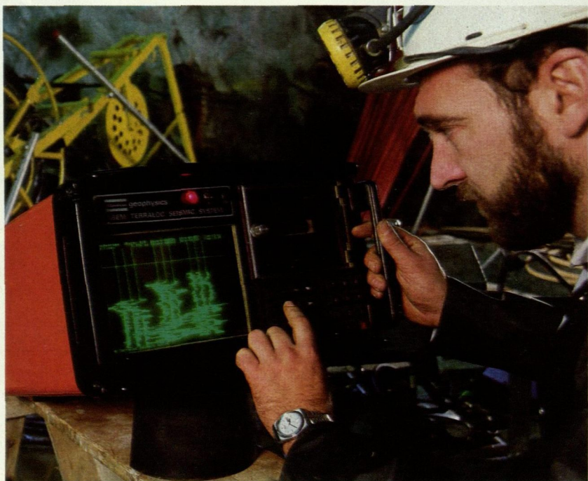
ABEM Terraloc Seismograph används här i Stripagruvan i Bergslagen för undersökning av sprickbildning i berg. Detta forskningsprojekt syftar till att finna lämpligt berg för deponering av kärnkraftavfall.
