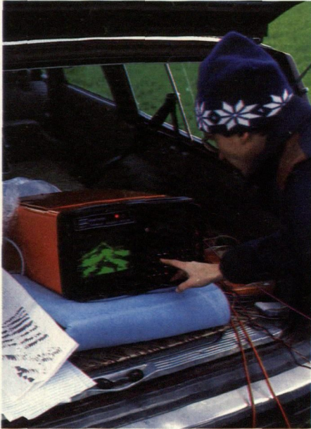
Atlas Copco ABEM presenterade under året sin nyutvecklade produkt Terraloc, ett datoriserat instrumentsystem för markundersökning. Med det nya instrumentet precisionsmätts bl a djupet till, och beskaffenheten hos berggrunden.
