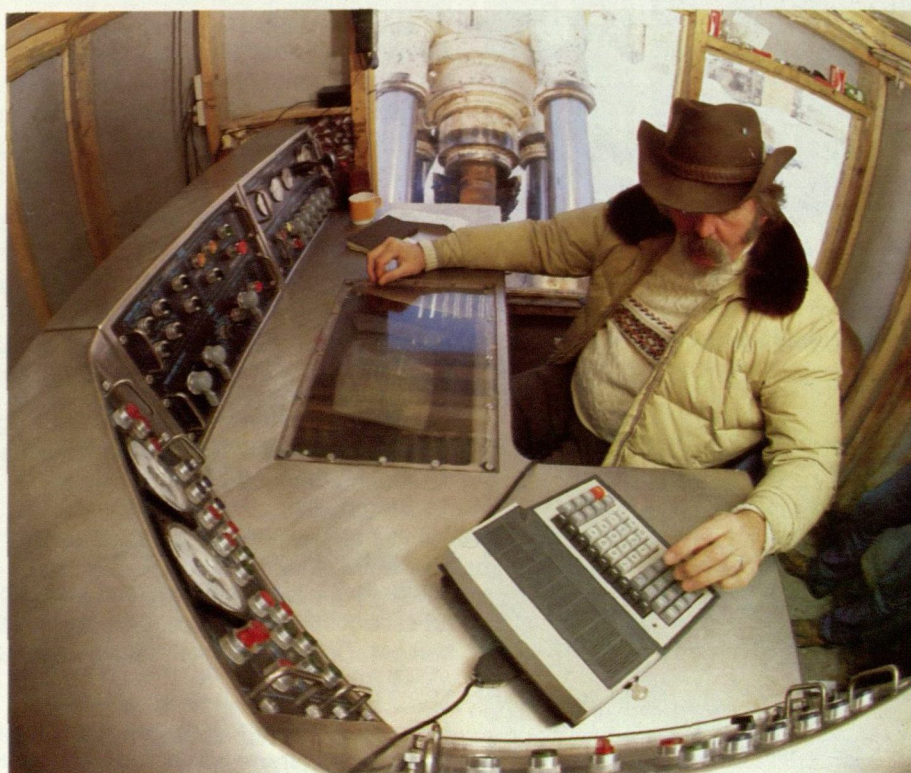
Atlas Copco Jarva introducerade under året en nyutvecklad stigortsmaskin för borrhning av vertikala schakt utan sprängning. Maskinen manövreras från en mikrodatorutrustad manövercentral som också möjliggör automatisk drift.
