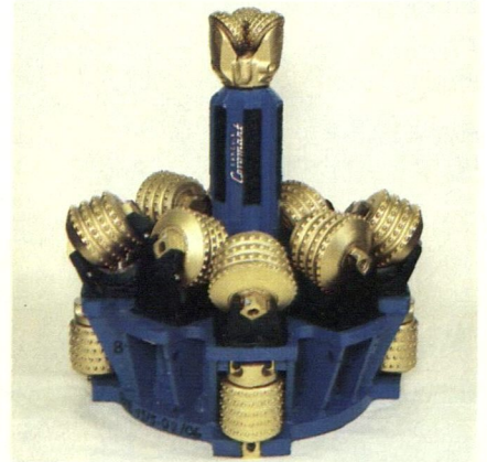
Sandvik Coromant blindhålshuvud innebär en ny teknik för stigortborrning. Borrhuvudet som introducerats under 1980, marknadsförs av Atlas Copco över hela världen.
