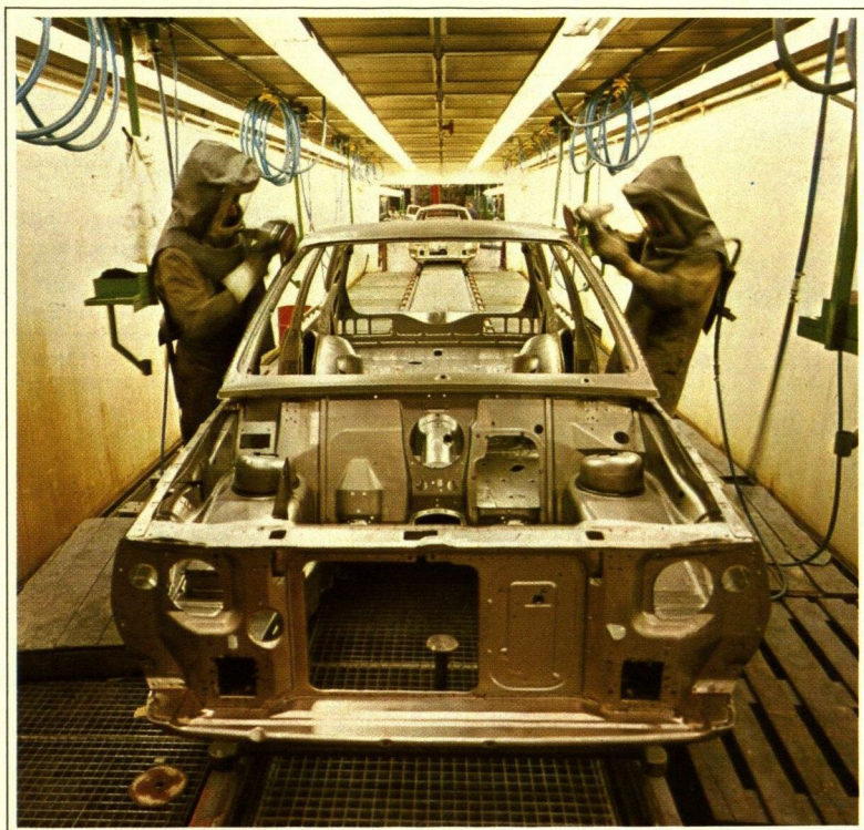
Vid Volvos anläggningar i Born, Holland, ingår Atlas Copcos verktyg och utrustningar i så gott som varje steg av produktionsprocessen. Slipmaskiner typ LSS 52 används här för att få fram fin yta på karossen till en Volvo 343.
