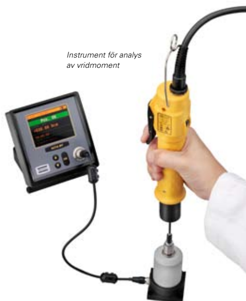
System för pulsmutterdragare med ökad noggrannhet och uppföljning
