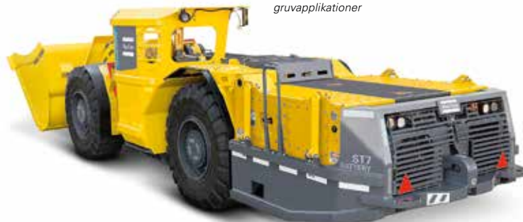
Batteridrivna underjordslastare för gruvapplikationer
