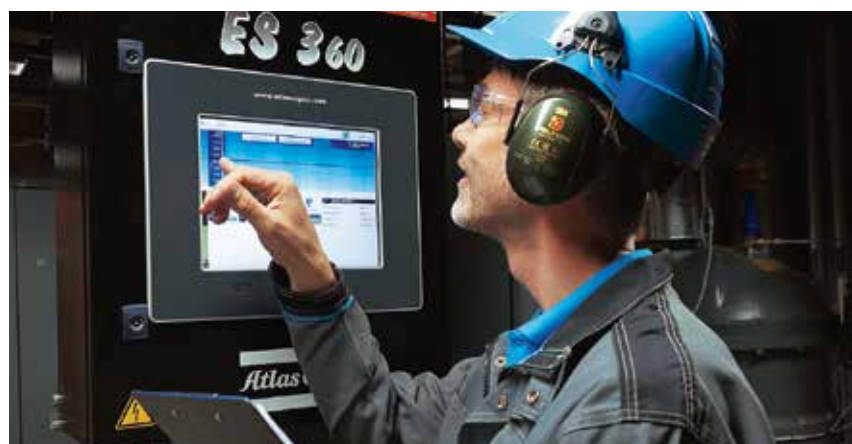
Om bilden: Effektiv kompressorstyrning är ett snabbt sätt för att uppnå energibesparingar. Användningen av avancerade kontrollsystem kan spara energi. Atlas Copcos styrenhet ES 360 kan ansluta upp till 60 maskiner.
